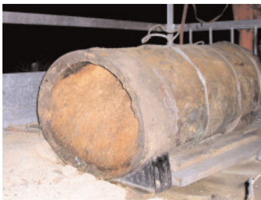
Luftmine ohne Bodenverschlussplatte
